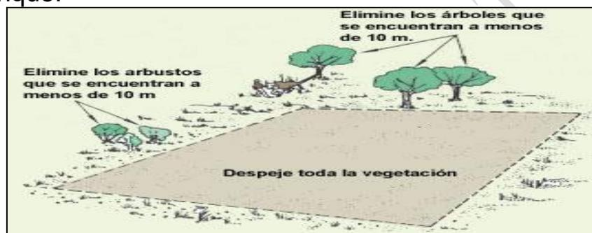
**Fig. 9. Limpieza del área y trazado del estanque**
