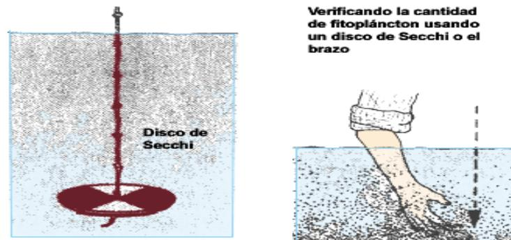
**Figura 21. Medición de la transparencia del agua mediante el disco secchi y el uso del brazo.**
